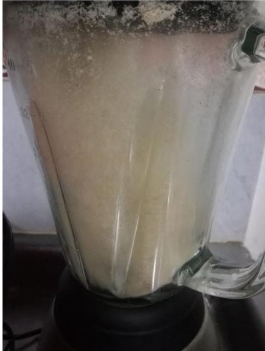
Ilustración 17. Triturando la fibra de bagazo de caña
