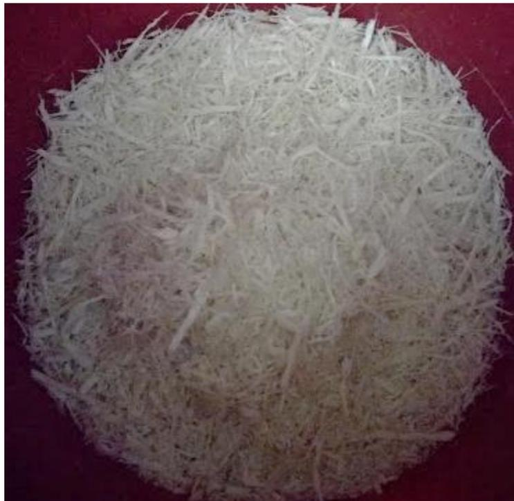
Ilustración 18. Porción de fibra de bagazo de caña triturada.
